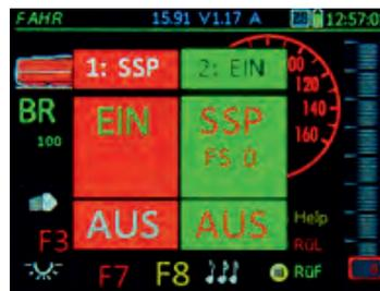
◀ Kurzschluss auf Schiene 1, der Strom wird abgeschaltet! Sofort wird in allen Fahrpulten das Stopp-Fenster mit dem aktuellen Zustand der Schienenanschlüsse sowie der weiteren Möglichkeiten gezeigt. Ein TOUCH auf die jeweilige Fläche am Bildschirm führt zurück zu FAHR oder zum Sammelstopp.
