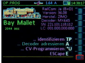
◀ Programmieren im „Operational Mode“ (OP PROG) beginnt mit der automatischen Identifizierung des Decoders, d.h. Auslesen einiger wichtiger CVs wie Decoderhersteller, -typ, Software Version, UID und Ladecode. Das Programmieren kann danach oder nach Unterbrechung sofort beginnen.
