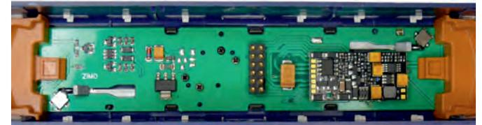
Lokplatine in der Roco E10 mit Ansteuerung der Mikro-Motoren für die Pantos; Federkontakteleiste zur Dachplatine, Sound-Decoder MX645P22.
