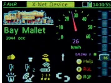
◀ Dieses Bild erscheint, wenn ein anderes Fahrpult das Fahrzeug im Vordergrund steuert. In diesem Fall handelt es sich um ein über das XpressNet angeschlossenes Fahrpult (oder App) wie im oberen Balken zu erkennen ist.
