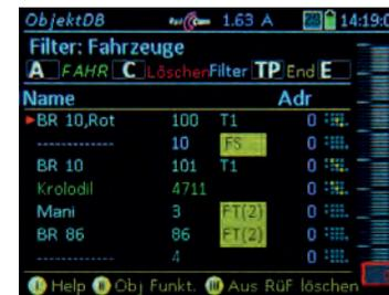
◀ Die **Objekt-Datenbank** ist eine Liste aller jemals aktiven Fahrzeuge (Adressen) des Systems (MX10 und MX32); Fahrzeuge im **RüF** (Rückholpeicher): grün; Fahrzeuge in anderen Fahrpulten: blau; inaktive Triebfahrzeuge im Basisgerät MX10: grau. Zu jeder Adresse werden der Name, die Geschwindigkeit, die Fahrtrichtung, die F-Tasten und ev. Mehrfachtraktionen angezeigt.
