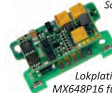
Die spezielle Lokplatine mit aufgestecktem MX648P16 für Fleischmann „Berg“ Lok.
